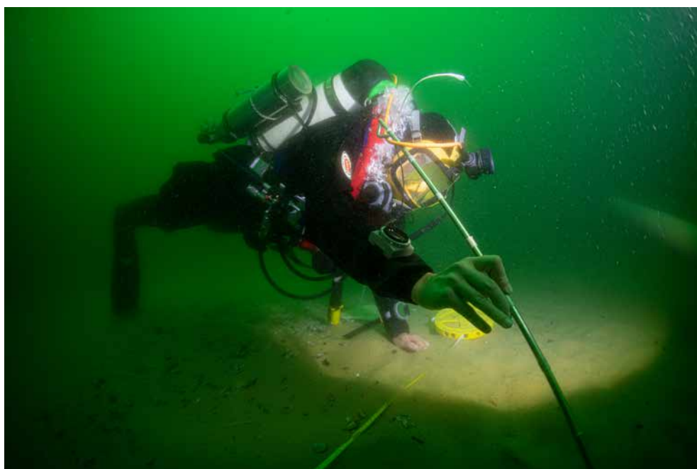
Afb. 19 Duiker sondeert locaties waar een magnetische anomalie werd aangetroffen.
