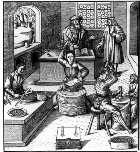
Afb. 42 Houtsnede van Leonhard Beck (c. 1480-1542), waarop te zien is hoe Maximiliaan I (1459-1519) leert hoe munten worden geproduceerd. De persoon links knipt munten uit een plaat (bron wikimedia commons).
