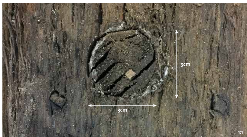
Afb. 25 Spijkerpennen en houten pennen in één van de huidplanken (KPW-4) van het Koperplatenwrak.
