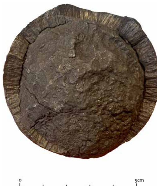
Afb. 31 Bij deze opengebarsten kanonskogel (vnr 62) is duidelijk te zien dat de kern en mantel op verschillende momenten zijn gegoten.
